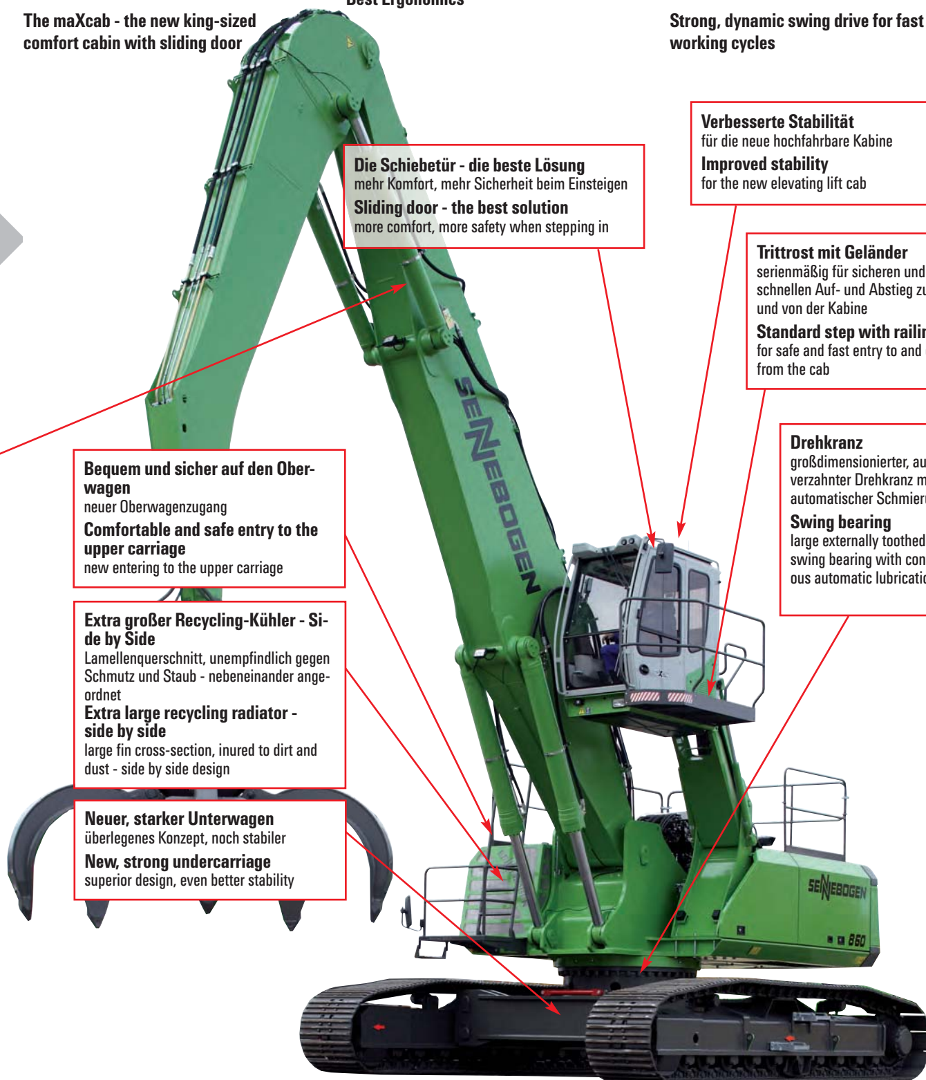
Die maXcab - die neue Großraum-Komfortkabine mit Schiebetür
