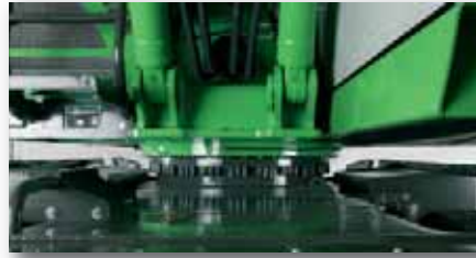
Starker, dynamischer Drehantrieb für schnelle Arbeitsspiele Strong, dynamic swing drive for fast working cycles
